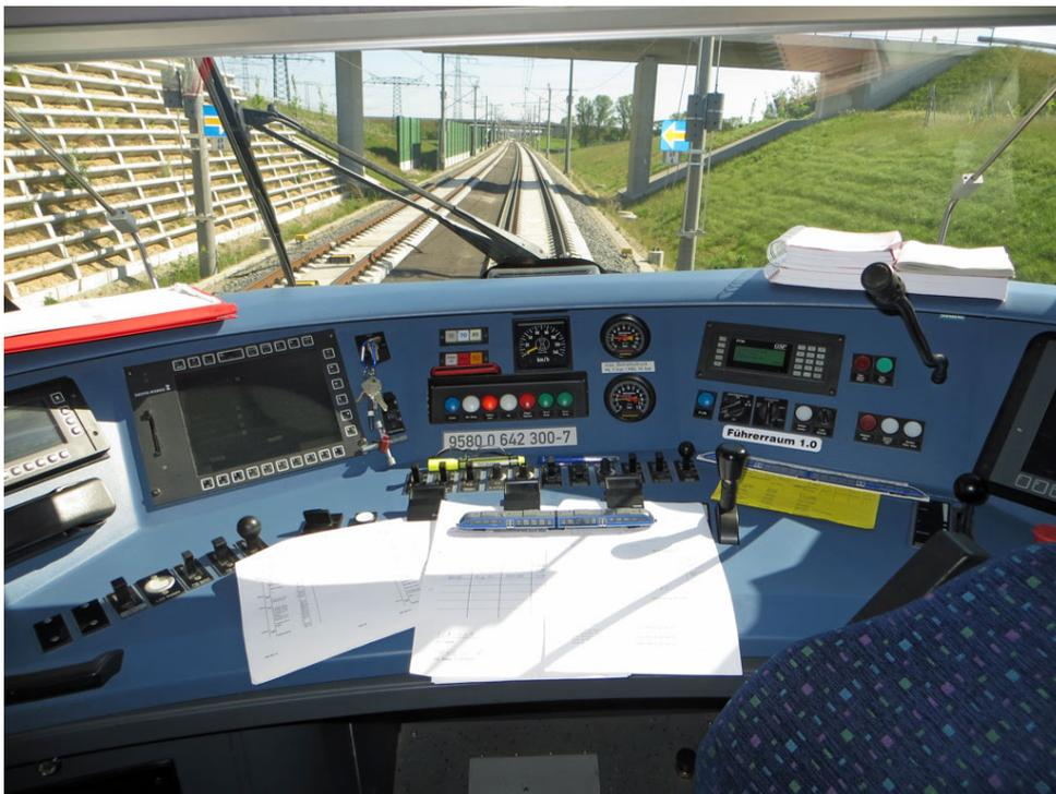
Das Signal 69A ist kein Lichtsignal, sondern streckenseitig nur mit einem [ETCS Stop Marker Ne 14](#) gekennzeichnet. Diese Nebensignale kennzeichnen einen Ganzblock, entsprechen also einem Lichtsignal auf LZB-Strecken. Formell bedeuten sie „Halt für Züge in ETCS-Betriebsart SR“ An der [Balisengruppe](#) des Signals (zwei [Eurobalisen](#) sind im Gleis der Gegenrichtung zu erkennen) wird deshalb auch ein [Packet P137/Stop if in Staff Responsible](#) ausgegeben.
