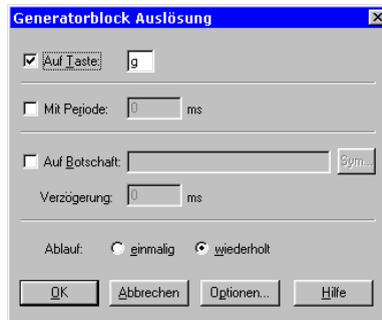
Abbildung 11: Auslösen einer Nachricht im CANalyzer
